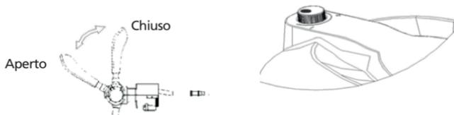
Allentare la guaina della bombola di CO2 (come mostrato in figura A), inserire una cartuccia da 16g di CO2 nella guaina (Figura B), e avvitare la guaina stretta fino a quando si sente un "click" (Figura C), che indica che la tenuta della cartuccia è stata bucata e che il gas CO2 può fluire nel fusto liberamente. Assicurarsi che la guaina della bombola sia fissata saldamente al coperchio superiore.
