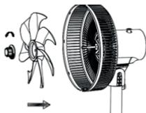
6. Posizionare la griglia anteriore (1) sulla griglia posteriore centrandola tramite l'apposito gancio posto in alto. Utilizzare la clip inferiore per fissare le due griglie e serrare la vite.
